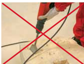
Laisser le câble d'alimentation à l'arrière de la machine
