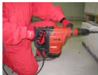
En position basse, les deux mains sur la machine et un genou à terre
