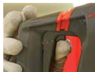
Blocage de l'interrupteur pour la position burinage
