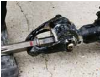
Introduire le burin dans l'emmanchement (partie plate sur le dessus)
