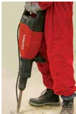
En burinage au sol, les deux mains sur la poignée supérieure
