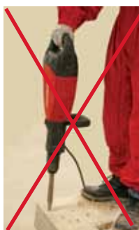
Toujours tenir la machine à deux mains
