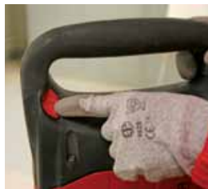
Blocage de l'interrupteur pour la position burinage
