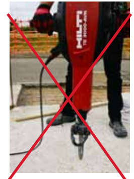
Ne jamais buriner avec l'étrier de verrouillage
