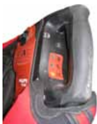
Réglage de la puissance : si le voyant est allumé, puissance 50% (1)
