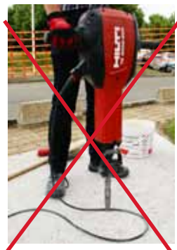
Toujours tenir la machine à deux mains
