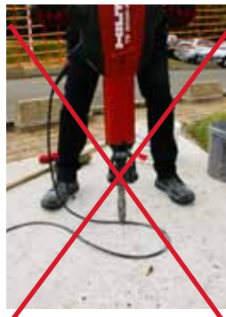
Laisser le câble d'alimentation à l'arrière de la machine
