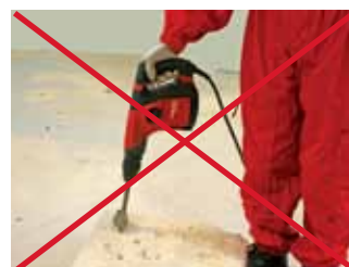
Toujours tenir la machine à deux mains
