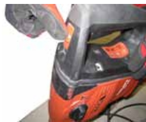
Blocage de l'interrupteur pour la position burinage (1)
