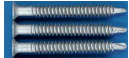
Fig. 20: VSchroeven met een meerlagige, uiterst corrosiebestendige coating na 15 cycli van de corrosietest met zwaveldioxide (corrosievrij)
