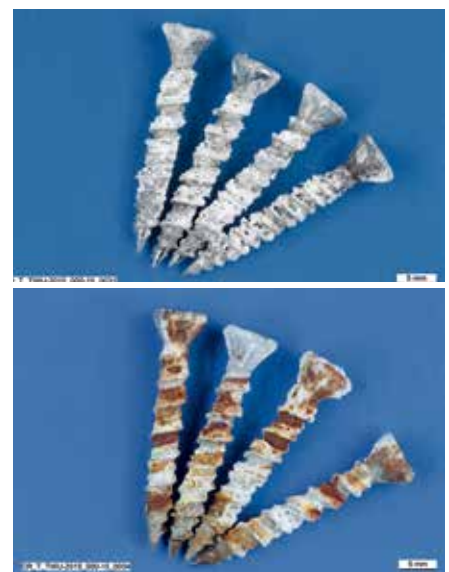
Fig. 14: Elektrolytisch gegalvaniseerde schroeven met een zinkcoating van ongeveer 5 µm na 48 u (bovenaan) en 96 u (onderaan) in de zoutsproeitest.
