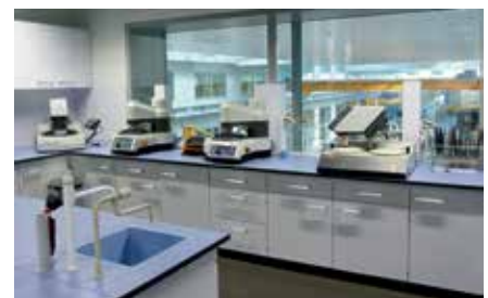
Fig. 23: Uitrusting van het metallografisch laboratorium (slijpen en polijsten)
