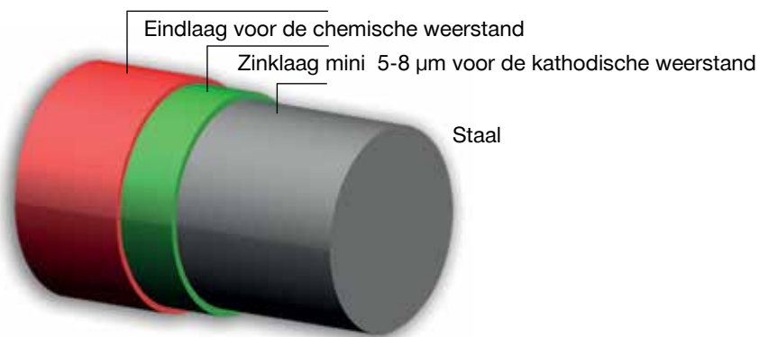
Fig. 32: Illustratie van een meerlagige coating op bevestigings- en verbindingmiddelen
