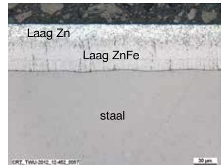
Fig. 30: Microscoopbeeld van thermisch verzinkt staal
