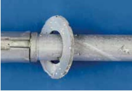
Fig. 5: Fasen van putcorrosie op roestvrij staal
