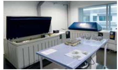
Fig. 13: Ons corrosielaboratorium met kasten voor zoutsproeitesten en cyclische corrosietesten
