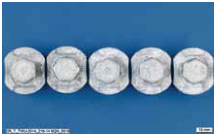
Fig. 18: Deel van een connector met meerlagige coating (deklaag van organische vlokken) na tien weken in de ISO 20340-test met UV-bestraling
