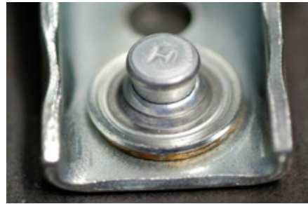
Empreinte du piston sur la rondelle
