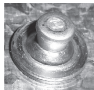
Empreinte du piston sur la rondelle
