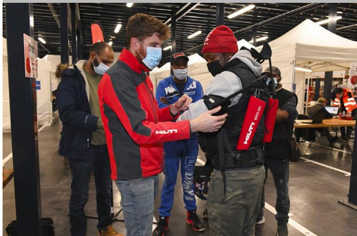
Mise à disposition des exosquelettes et formation des utilisateurs (SNIE)
