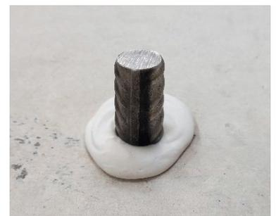
Figure 4-3 : Barre d'armature juste après sa mise en place avec le HIT-FP 700 R
