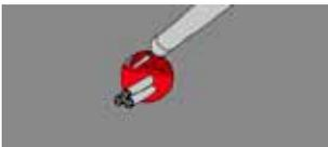
**Appliquer le mastic CFS-IS :** Appliquer jusqu'à la profondeur requise, afin d'obtenir la protection coupe-feu désirée. S'assurer que le mastic CFS-IS est en contact avec toutes les surfaces pour fournir une adhésion maximum.
