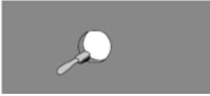
**Nettoyer l'ouverture :** L'ouverture doit être solide, sèche, exempte de poussière et de graisse.
